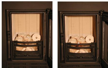
Teilen Sie die Holz-Brikks in 2 bis 3 (max. 1kg schwere) Stücke und legen Sie diese in den Heizeinsatz (siehe Abb.3). Brechen Sie einige Scheiben vom Stück ab, schichten Sie diese zeltförmig im oberen Drittel in den Heizeinsatz und zünden sie am besten mit Holzanzündern an. Die Holz-Brikks entflammen mühelos und schnell. Danach ist die Verbrennungsluftklappe gemäß Einstellanweisung in Position zu bringen.
