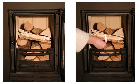
Um bei unterschiedlicher Brennstoffmenge einen etwa gleich hohen Brennstoffstoß zu erzielen, müssen Sie beim Verheizen von wenig Brennstoff die Scheiter locker schichten, bei viel Brennstoff entsprechend dicht. Die Füllhöhe sollte 2/3 des Brennraumes nicht überschreiten.
