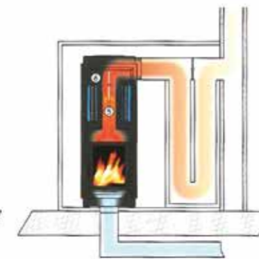
3 Heizgasumschaltklappe (bauseits) 4 Nachheizfläche
