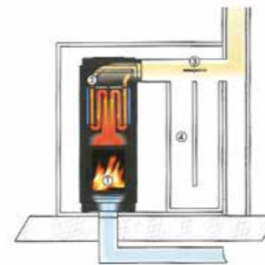
1 Feuerraum 2 Integrierter Wärmetauscher
